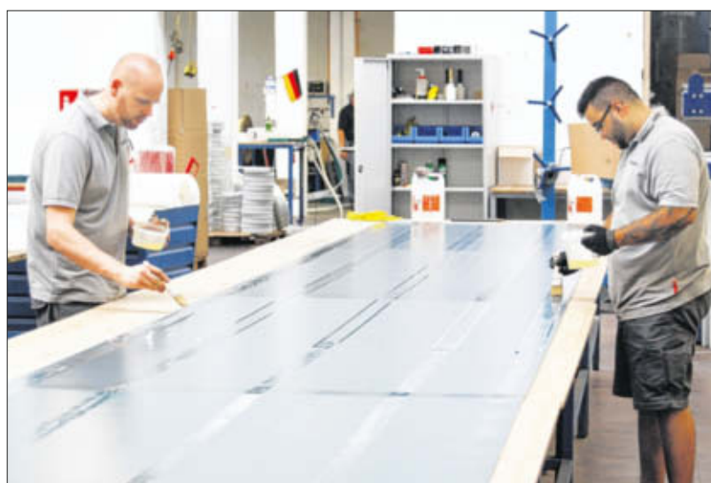
Tobias Gaus (links) und Emre Eroglu beschichten in der Produktionshalle ein riesiges Transportband mit Leisten.
